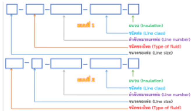
ภาพที่ 4 องค์ประกอบหมายเลขประจำท่อ (Pipe line number)
