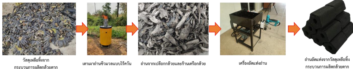
ภาพที่ 1 กระบวนการผลิตถ่านอัดแท่งจากวัสดุเหลือทิ้งกระบวนการผลิตกล้วยตาก
